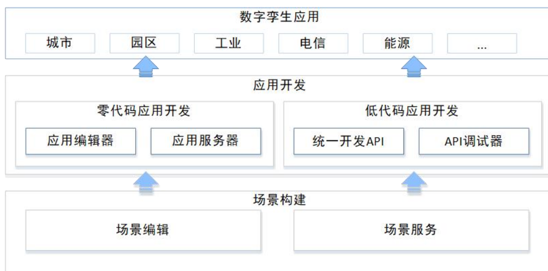
图1 数字孪生低代码平台技术框架
